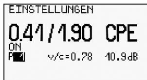
2 | Durch kurzes Drücken der Taste ESC sind die zu verändernden Parameter anzuwählen (invertierte Darstellung) und mit den Tasten [→] und [←] zu ändern. Nicht benötigte Speicherplätze können dabei mit dem Parameter »ON« oder »OFF« ein- und ausgeblendet werden. Ausgeblendete Speicherplätze erscheinen beim Einschalten nicht. Die veränderbaren Parameter sind:
